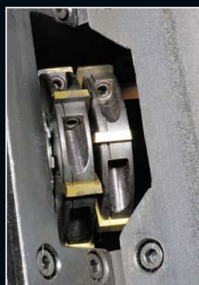
2 Frässcheiben gekoppelt mit je 6 Wendepplatten
