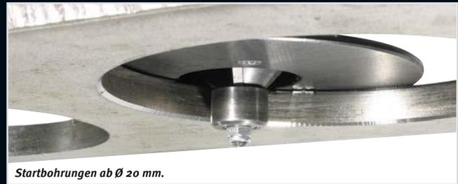
Startbohrungen ab  $\varnothing$  20 mm.
